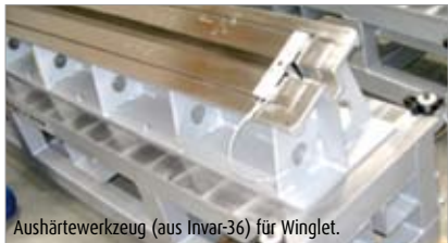
Aushärtewerkzeug (aus Invar-36) für Winglet.
