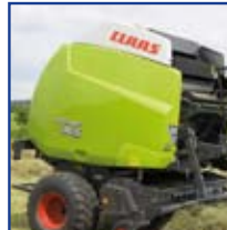
Seitenverkleidung für Rundballenpresse.
