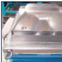
SMC-Werkzeug für Motorhaube.
